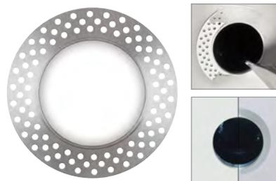
**Anneau de plâtrage (FT):** anneau de plâtrage profilé en aluminium usiné procurant une nervure soulevée pour plâtrer jusqu'à une épaisseur de bordure de 3/16 po. L'anneau est rattaché au plafond plutôt que sur le cadre de montage afin d'éviter la conduction de chaleur et la vibration qui peuvent causer le jaunissement ou le fendillement du plâtre.
