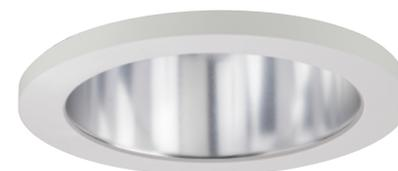
**À l'épreuve du vandalisme (VP):** procure une solution élégante pour les besoins de résistance au vandalisme. Un anneau d'aluminium monobloc usiné avec une lentille claire résistante aux impacts. Le modèle sans bordure (F) peut être commandé. Le luminaire offre une classification IK10 contre les impacts et un indice de protection IP65.
