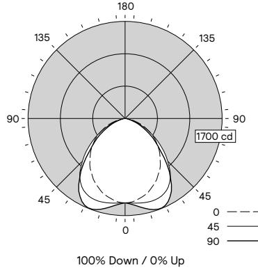
Les tracés de candelas illustrés s'appliquent à la configuration de 4000 lm/4 pi, IRC de 90 à 3500K.
