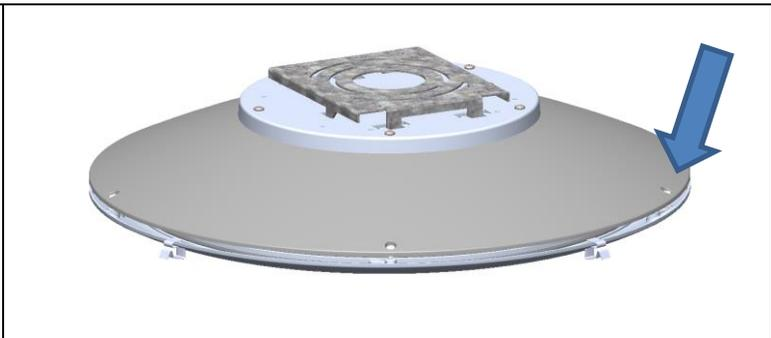
PUSH IN THE FOUR WIRE GUARD CLIPS IN THE LOWER CASTING LIP IN BETWEEN UPPER LENS AND LOWER CASTING. THE FOUR CLIPS SHOULD BE EVENLY ARRAYED AROUND THE LOWER CASTING.
