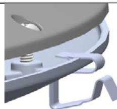
INSTALLER LE PROTECTEUR DE FIL MÉTALLIQUE DANS LA PREMIÈRE AGRAFE SOUS LES DEUX ANNEAUX SUPÉRIEURS. UTILISER LA PINCE À BEC EFFILÉ POUR ÉCARTER L'AGRAFE. S'ASSURER DE PORTER DES GANTS PENDANT LA MANIPULATION DE L'AGRAFE.
