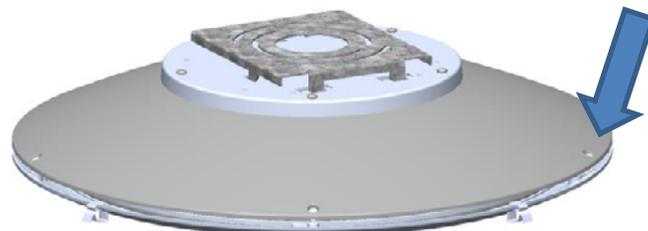
INSÉRER LES QUATRES AGRAFES DU PROTECTEUR DE FIL MÉTALLIQUE DANS LE BORD DU BOÎTIER COULÉ INFÉRIEUR ENTRE LA LENTILLE SUPÉRIEURE ET LE BOÎTIER COULÉ INFÉRIEUR. LES QUATRES AGRAFES DEVRAIENT ÊTRE DISTRIBUÉES UNIFORMÉMENT AUTOUR DU BOÎTIER COULÉ INFÉRIEUR.
