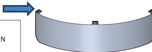
METTRE LA PROTECTION SUR LA LENTILLE SUPÉRIEURE DE FAÇON QUE LES TROIS LANGUETTES ADHÈRENT À LA LENTILLE ET QUE LA PROTECTION SOIT SUSPENDUE.
