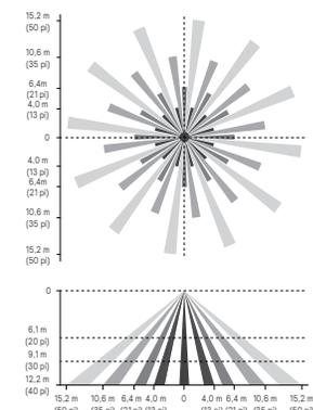
**Note:** les configurations de faisceaux ne sont illustrées que pour un guide général et ne sont pas à l'échelle. Les capacités de captation et de couverture dépendent de plusieurs facteurs dont la taille, la vitesse et la direction des déplacements des personnes et des véhicules; la hauteur de montage, les conditions environnementales et du site; etc.
