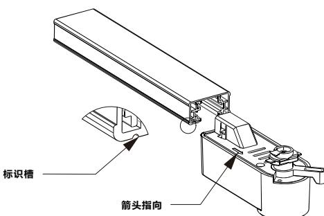
安装时请将轨道上的标识槽对应导轨盒箭头方向，请勿反装。
