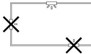
建议轨道安装在天花板上，禁止安装在侧墙及地面。
