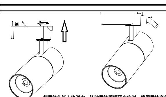
将导轨头嵌入轨道内，转动导轨手柄至止位时，确保导体充分接触。
