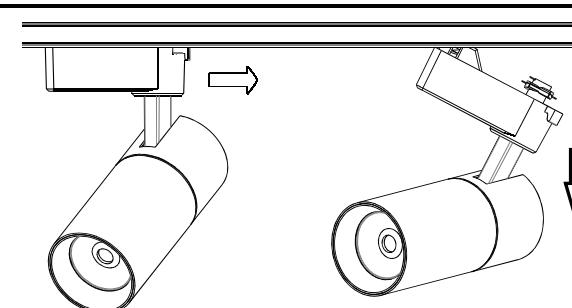
将导轨头转动到另一端，依据图示倾斜灯具，直接拔出轨道。
