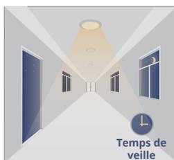
Une fois le temps d'attente écoulé, le capteur tamise la lumière pour qu'elle corresponde au niveau de gradation de veille.
