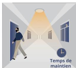
Lorsqu'aucun mouvement n'est détecté, le détecteur maintient la lumière allumée à pleine puissance pendant le temps d'attente.
