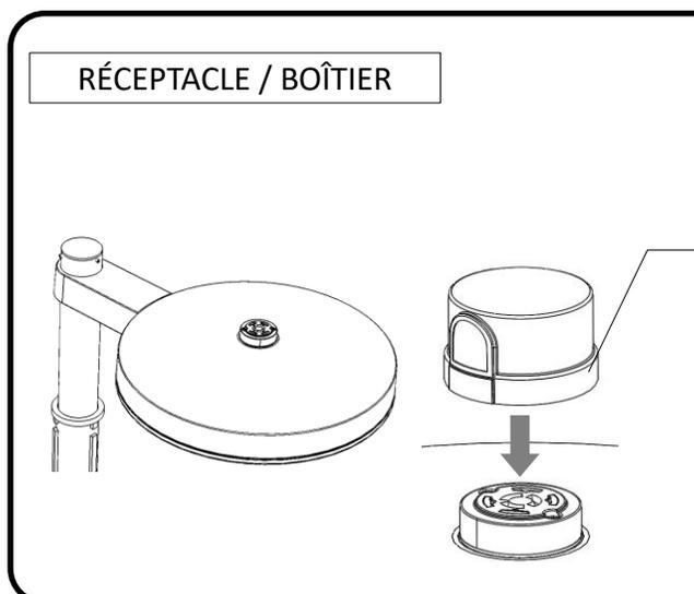
**Réceptacle placé directement sur le boîtier (S-OSAC) :** Cette option n'est pas ajustable. Il est important d'utiliser un capuchon de court-circuit IP66, une cellule photoélectrique ou un autre dispositif compatible avec cette option.
