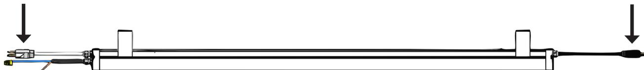
Modelo DALI (PSD) - fornecido com conectores para fios 1 - 1,5m<sup>2</sup>
