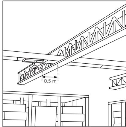
Não instale o sistema Interact até que as construções de metal ou concreto estejam finalizadas
