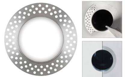
**Anneau de plâtrage (FMR):** anneau de plâtrage profilé en aluminium usiné procurant une nervure soulevée pour plâtrer jusqu'à une épaisseur de bordure de 3/16 po. L'anneau est rattaché au plafond plutôt que sur le cadre de montage afin d'éviter la conduction de chaleur et la vibration qui peuvent causer le jaunissement ou le fendillement du plâtre.
