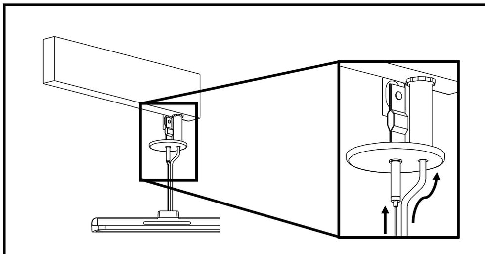
INSÉRER LES CÂBLES D'AÉRONEF DANS LES DISPOSITIFS DE RÉGLAGE. INSÉRER LE CÂBLE D'ALIMENTATION DANS LE MODULE DU RÉGULATEUR (POUR LE CÂBLAGE VOIR LA SECTION SPÉCIFIQUE AU MODULE DU RÉGULATEUR)
