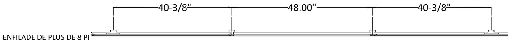
\*SEULS LES LUMINAIRES À L'EXTRÉMITÉ SONT INSTALLÉS À 40-3/8 PO. LES LUMINAIRES DU MILIEU SONT INSTALLÉS À 48 PO.\*
