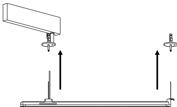
SUSPENDRE LES LUMINAIRES À L'EXTRÉMITÉ DE LA PREMIÈRE ENFILADE.
