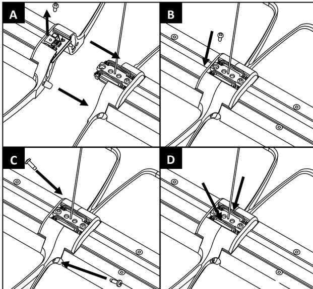
RÉINSTALLER LA VIS DANS LA PLAQUE TRANSVERSALE DU RACCORD
