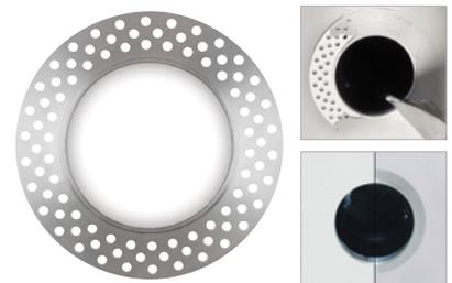
**Anneau de plâtrage (FT)**: anneau de plâtrage profilé en aluminium usiné procurant une nervure soulevée pour plâtrer jusqu'à une épaisseur de bordure de 3/16 po. L'anneau est rattaché au plafond plutôt que sur le cadre de montage afin d'éviter la conduction de chaleur et la vibration qui peuvent causer le jaunissement ou le fendillement du plâtre.
