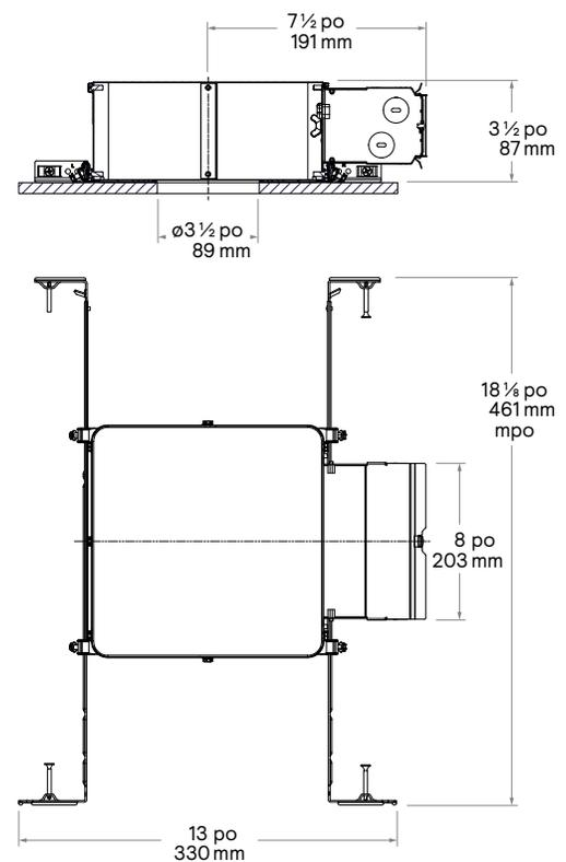
Requiert un accès par le dessus ou un espace de plénum de 19 po sans capteur et de 22 avec capteur.
