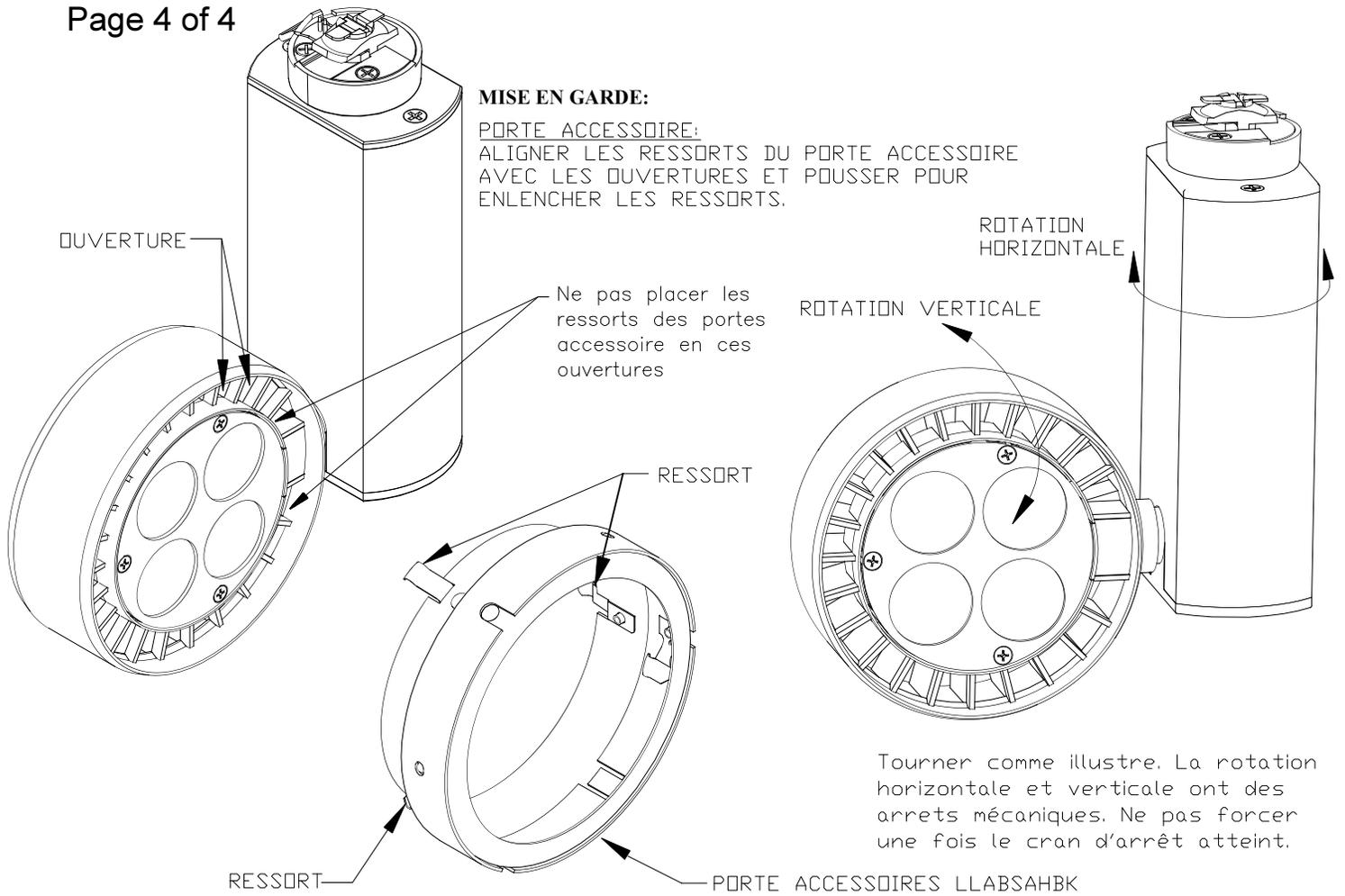
Tourner comme illustre. La rotation horizontale et verticale ont des arrêts mécaniques. Ne pas forcer une fois le cran d'arrêt atteint.
