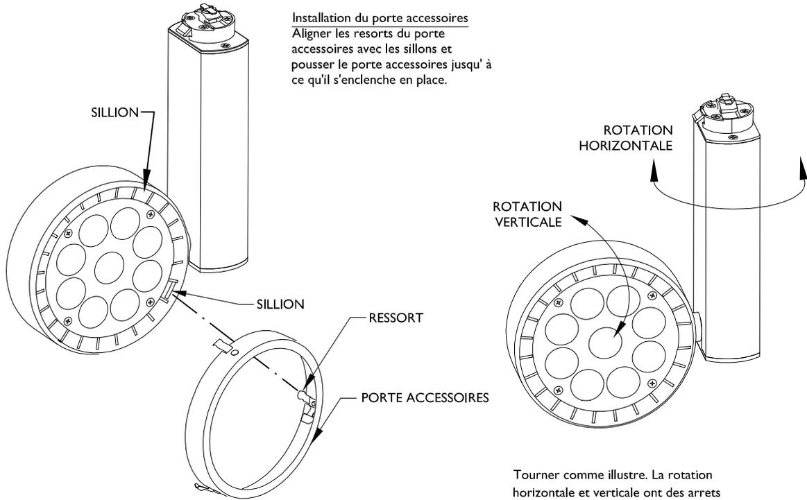
Tourner comme illustre. La rotation horizontale et verticale ont des arrêts mécaniques. Ne pas forcer une fois le cran d'arrêt atteint.
