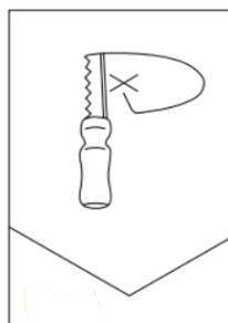
Remarque : Pour la série 4 po, utilisez un orifice de 4.5" and 6 po, utilisez un orifice de 6.5"
