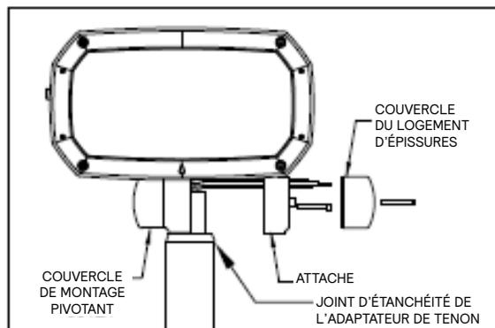
6. LE LUMINAIRE PEUT ÊTRE ORIENTÉ DANS UN AXE VERTICAL EN DESSERRANT LES BOULONS DE L'ATTACHE ET EN PIVOTANT LE LUMINAIRE TEL QUE DÉSIRÉ. POUR ORIENTER DANS UN AXE HORIZONTAL, DESSERRER LE BOULON AU CENTRE DU COUVERCLE DE MONTAGE PIVOTANT. CHAQUE MARQUE SUR LE COUVERCLE DE MONTAGE INDIQUE 15°. LES DENTS INTERNES VERROUILLENT À CHAQUE 5°. RESSERRER LES BOULONS LORSQUE L'ORIENTATION EST ATTEINTE.
