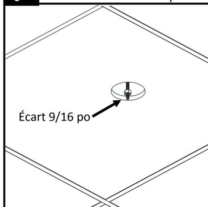
**IMPORTANT** : s'assurer que le dessous de l'écrou est éloigné de 9/16 po de l'extrémité du boulon 1/4 po-20.
