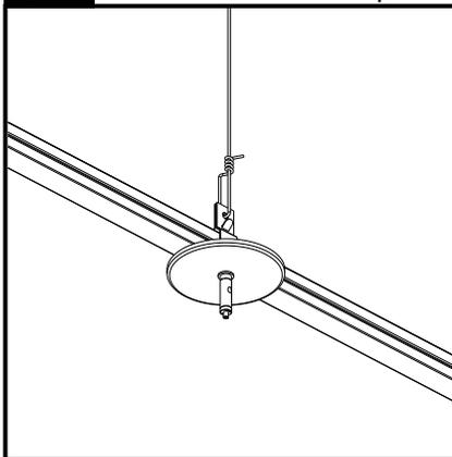
**IMPORTANT**: s'assurer que le serre-câble est bien serré sur l'espaceur et sur l'agrafe Caddy avant d'installer le luminaire.
