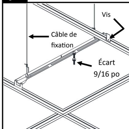
Rattacher le câble de fixation (non inclus) pour supporter la barre transversale sur la structure. En dessous du plafond installer le deuxième écrou 1/4po-20 sur le boulon 1/4 po-20. **IMPORTANT**: verrouiller la barre transversale sur le profilé en T à l'aide de fixations adéquates (non incluses).
