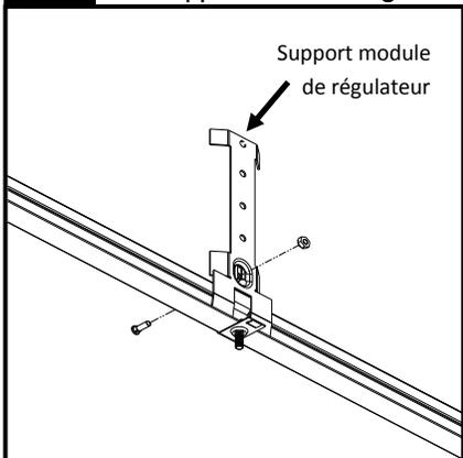
Rattacher le support du module de régulateur sur l'agrafe Caddy avec l'écrou hexagonal et le boulon à tête carrée inclus dans la trousse de montage. S'assurer que pièces sont orientées et installées tel qu'illustré.
