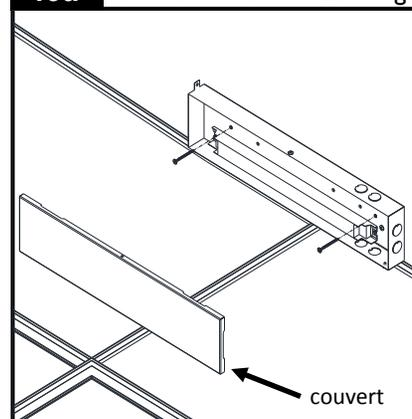
Le module de régulateur peut aussi être monté sur un mur au-dessus du plafond. Dans ce cas, retirer les vis du couvert. S'assurer que le couvert de câblage est scellé et rattaché à l'arrière du boîtier du module de régulateur. Utiliser les bonnes fixations (non incluses) pour rattaché le boîtier à la structure.
