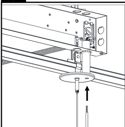
Insérer le cordon d'alimentation dans le plafonnier et le raccord dans le boîtier du module de régulateur.
