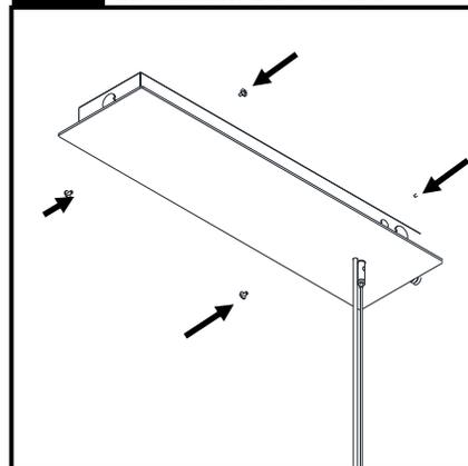
Rattacher le couvert du boîtier du module de régulateur avec les 4 vis retirées à l'étape 12.
