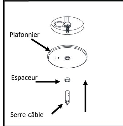
Aligner la rondelle du plafonnier avec le raccord et installer le plafonnier, l'espaceur et le serre-câble tel qu'illustré. Bien serrer le serre-câble sur le boulon 1/4 po-20. **IMPORTANT** : au-dessus du plafond serrer l'écrou sur le plafonnier pour rattacher toutes les composantes.
