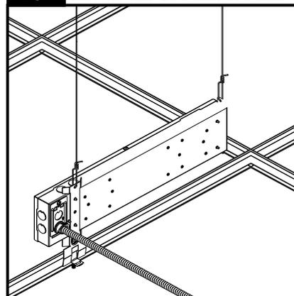
Insérer le couvert de câblage et le glisser en position afin de le verrouiller à l'intérieur du boîtier du module de régulateur.
