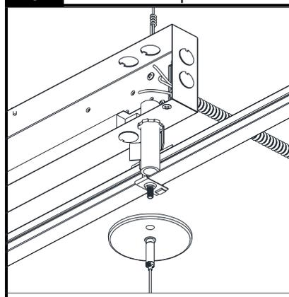
Vous référer aux étapes 4 à 8 de la page 1 pour rattacher le plafonnier, l'espaceur et le câble de suspension. S'assurer que l'entrée d'alimentation du plafonnier est alignée avec le raccord à l'intérieur du module de régulateur.
