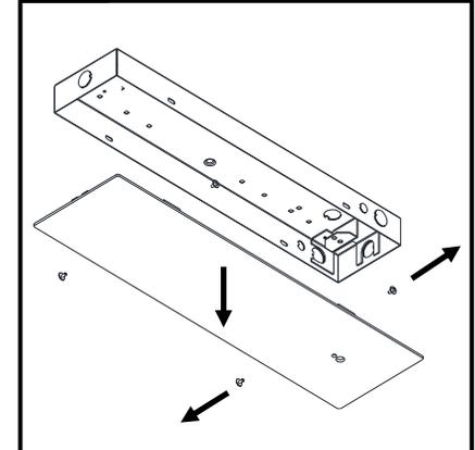
Retirer le boîtier du module de régulateur et 4 vis.
