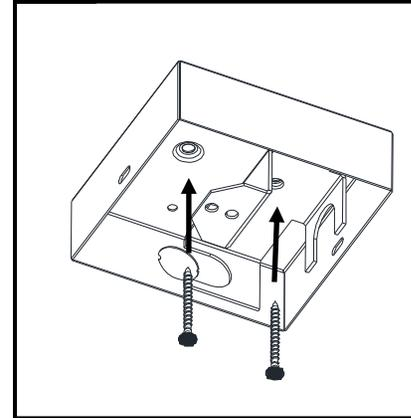
Installer le boîtier à l'endroit de montage requis. Rattacher à la structure à l'aide des attaches de fixations adéquates (non incluses).
