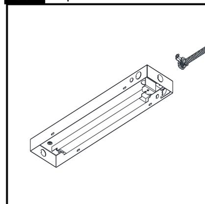
Déterminer la location requise pour l'alimentation. Retirer les entrées défonçables de 7/8 po dans le boîtier et rattacher le conduit électrique (non inclus).
