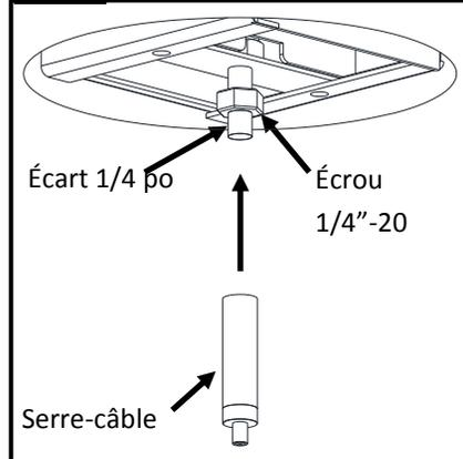
Installer l'écrou 1/4po-20 fourni dans la trousser de fixations. **IMPORTANT** : laisser un écart de 1/4 po en bas du serre-câble pour le rattacher. Installer le serre-câble sur la solive. Vous assurer que le serre-câble est bien serré sur l'écrou 1/4po-20.
