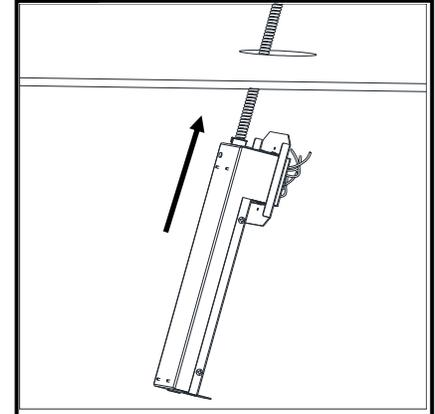
Débuter l'installation du module de régulateur en inclinant et en le guidant dans le trou du plafond.
