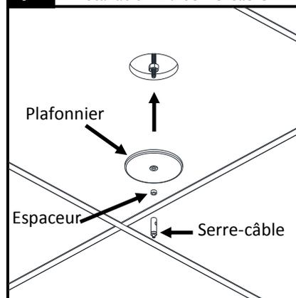
Installer le plafonnier, l'espaceur et le serre-câble tel qu'illustré. **IMPORTANT** : Serrer fermement le serre-câble sur le boulon 1/4 po-20, serrer l'écrou sur le plafonnier pour rattacher toutes les composantes.
