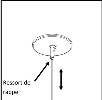
Le réglage du câble s'effectue en appuyant sur le ressort de rappel. **IMPORTANT** : vous assurer que le luminaire est bien supporté avant d'effectuer les réglages. Une fois les réglages terminés, couper l'excédent du câble sous le plafonnier
