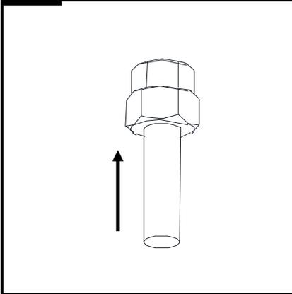
Préparer le boulon 1/4 po-20 pour l'installation en rattachant l'écrou 1/4 po-20 inclus dans la trousse de montage. S'assurer que l'écrou affleure la tête du boulon tel qu'illustré.
