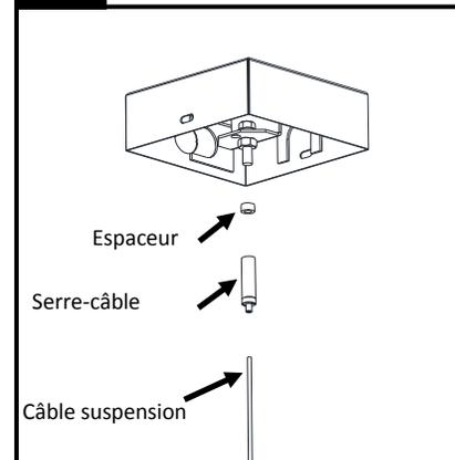
**IMPORTANT :** insérer le câble de suspension dans le couvert du boîtier retiré à l'étape 2. Installer l'espaceur et le serre-câble dans le boîtier le boulon 1/4 po-20 et serrer entièrement. **IMPORTANT :** bien serrer le serre-câble sur l'espaceur et le boulon 1/4 po-20.
