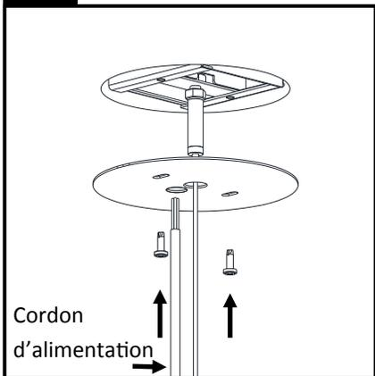
Insérer le cordon d'alimentation dans le plaque inférieure et descendre la plaque jusqu'au luminaire. Compléter les connexions de câblage basse tension dans la cavité de câblage du module de régulateur. Soulever la plaque inférieure vers le plafond et la rattacher sur le module de régulateur avec les vis incluses.
