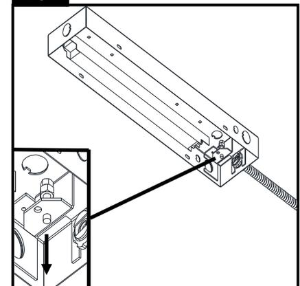
Insérer l'assemblage de boulon dans le support de montage et le pousser. **IMPORTANT** : vous assurer que la location du boulon est tel qu'illustré.
