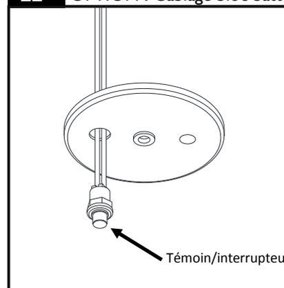
Pour l'installation du bloc batterie, déconnecter le témoin/interrupteur du boîtier du module de régulateur. Retirer l'écrou de blocage et l'installer dans le trou de 1-1/2 po dans le plafonnier tel qu'illustré.
