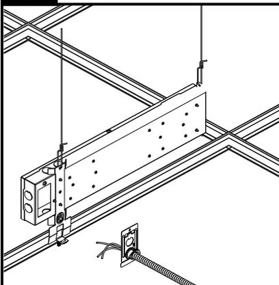
Raccorder l'alimentation avec le couvert de câblage.
