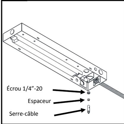
Installer l'écrou 1/4 po-20 et bien le serrer sur le support de montage. Installer l'espaceur et le serre-câble sur la tige 1/4 po-20. **IMPORTANT:** Bien serrer le serre-câble sur l'espaceur et sur l'écrou 1/4po -20.
