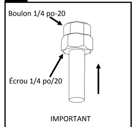
Pour les plafonds de placoplâtre de 1/2 po seulement, assembler le boulon de 1/4po-20 et l'écrou fourni dans la trousse de pièces de fixation. Pour les plafonds de placoplâtre de 5/8 po utiliser seulement le boulon 1/4 po-20, le boulon est pour la prochaine étape. S'assurer que l'écrou affleure la tête du boulon tel qu'illustré.
