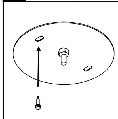
Fileter l'assemblage de la plaque inférieure dans la plaque supérieure jusqu'à ce qu'il y ait contact entre le dessous et le placoplâtre. Si requis, faire pivoter légèrement, aligner la fente de plaque inférieure avec le trou de la plaque supérieure et visser la vis incluse. Installer le deuxième 1/4 po-20 pour rattacher le support de montage. **IMPORTANT** : la vis doit être bien serrée sur l'écrou.
