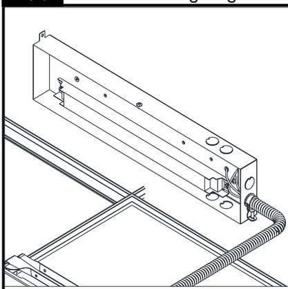
Rattacher le conduit flexible sans gaine de 1/2 po (non inclus) et le connecteur du conduit (non inclus) dans une des entrées défonçables disponibles dans le boîtier du module de régulateur.
