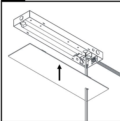
Soulever le couvert vers le plafond et aligner avec le câble de suspension et le serre-câble.
