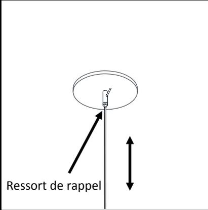
**IMPORTANT** : le réglage du câble s'effectue en appuyant sur le ressort de rappel. **ATTENTION** : vous assurer que le luminaire est bien supporté avant d'effectuer les réglages. Une fois les réglages terminés, couper l'excédent du câble sous le plafonnier.
