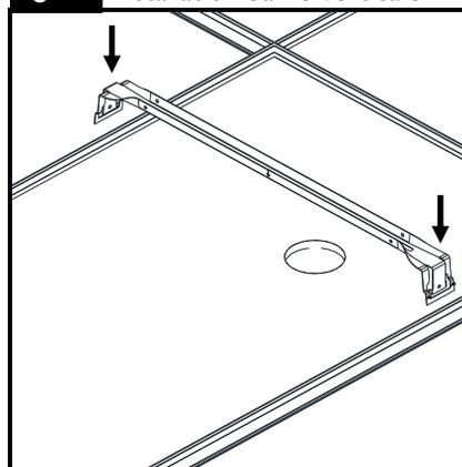
Retirer la tuile de plafond adjacente. Au-dessus du plafond, repérer la barre verticale Caddy logée au-dessus de l'endroit de montage et enclencher sur le profilé en T.
