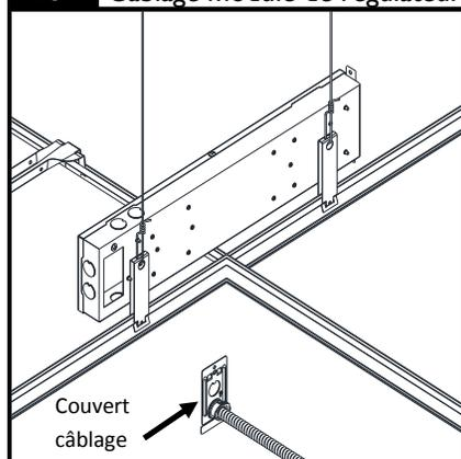
Rattacher le conduit flexible sans gaine de 1/2 po (non inclus) et le connecteur du conduit (non inclus) sur le couvert de câblage inclus.
