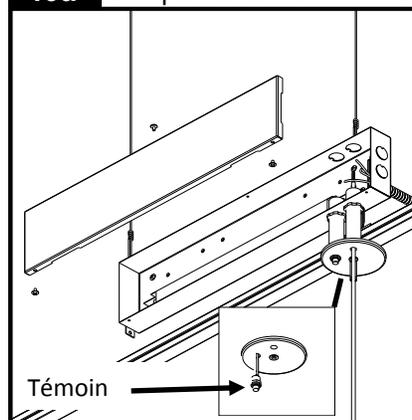
Pour l'option de bloc de batterie, retirer le témoin/interrupteur du module de régulateur. Installer le plafonnier à côté du trou d'alimentation. Installer le deuxième raccord inclus dans la trousser de montage sur le raccord d'alimentation. Vous référer aux étapes 4 à 8 de la page 1 pour rattacher le plafonnier, l'espaceur et le câble de suspension. Reconnecter le câblage de témoin/interrupteur.
