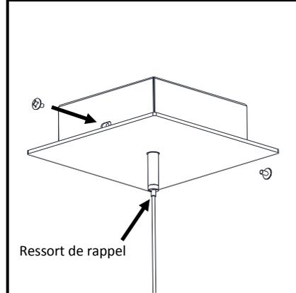
Réinstaller le couvert du boîtier et les vis retirées à l'étape 2. Le réglage du câble s'effectue en appuyant sur le ressort de rappel. **ATTENTION** : vous assurer que le luminaire est bien supporté avant d'effectuer les réglages. Une fois les réglages terminés, couper l'excédent du câble sous le plafonnier
