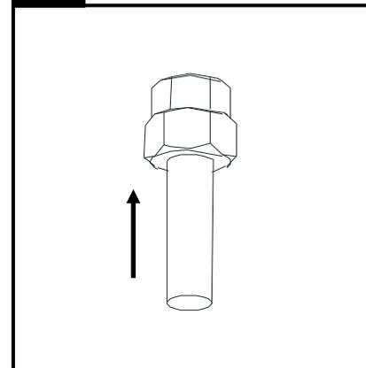
Préparer le boulon 1/4 po-20 pour l'installation en le rattachant à l'écrou 1/4 po -20 inclus dans la trousser de fixations. Vous assurer que l'écrou affleure la tête du boulon tel qu'illustré.
