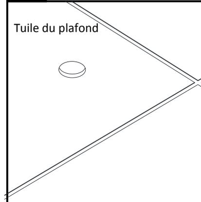
Consulter les dessins du plan fourni pour déterminer les locations exactes de montage. Sous le plafond avec une scie-cloche percer un trou de 3 po dans la tuile où sera le montage.
