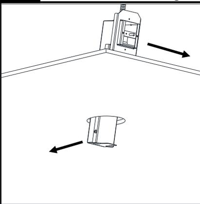
Lorsque vous entrez le module de régulateur dans le trou du plafond, incliner la section supérieure vers l'avant et la section inférieure vers l'arrière pour l'insérer entièrement dans le plafond.
