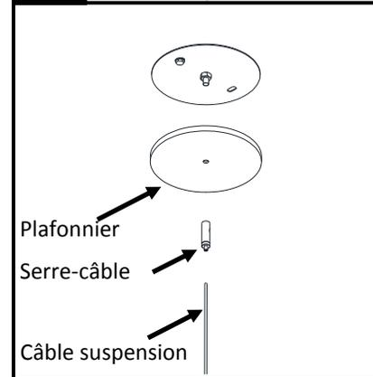
Glisser le plafonnier sur le 1/4 po-20 et installer le serre-câble. **IMPORTANT** : Serrer fermement le serre-câble sur le plafonnier et l'écrou 1/4-20 sous le dessous de la plaque inférieure.
