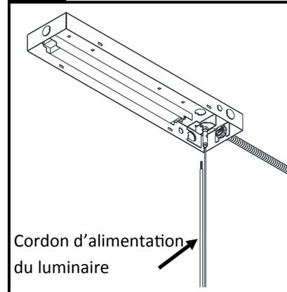
Insérer le cordon d'alimentation du luminaire dans le couvert du module de régulateur et du support de montage du boîtier du module de régulateur. Entrer l'excès de fil dans le boîtier. Couper tel que requis et terminer les connexions de câblage basse tension dans le boîtier du module de régulateur.
