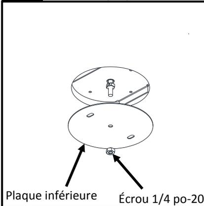
Glisser la plaque inférieure dans l'assemblage de tige 1/4 po-20. Installer le 1/4 po-20 fourni dans la trousser de fixations et bien serrer la plaque inférieure sur l'assemblage de tige. **IMPORTANT** : la plaque inférieure doit être bien rattachée.
