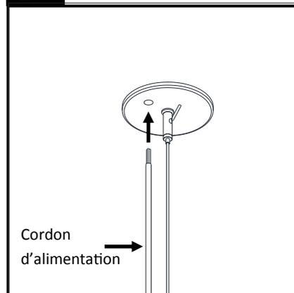
Insérer le cordon d'alimentation basse tension dans le trou du plafonnier et acheminer jusqu'au boîtier du module de régulateur pour effectuer les connexions de câblage.
