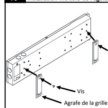
Installer les agrafes de la grille tel qu'illustré en utilisant les vis fournies dans la trousse de fixations.
