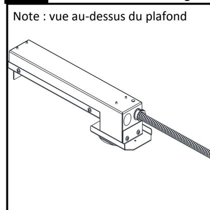
Replacer le module de régulateur et le positionner directement au-dessus du trou d'accès au plafond. Note : vue au-dessus du plafond illustrée pour référence seulement.
