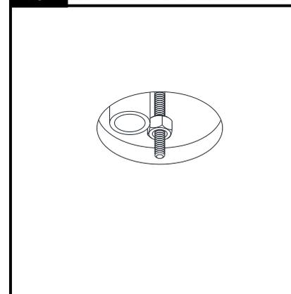
Sous le plafond, installer le deuxième écrou 1/4 po-20 inclus dans la trousse de fixations. **IMPORTANT**: s'assurer que le dessous de l'écrou est éloigné de 5/16 du dessous du boulon 1/4 po-20.
