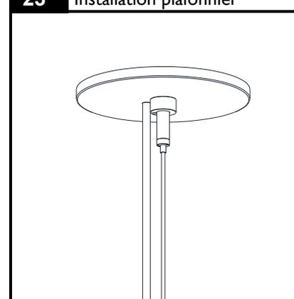
Bien appuyer le plafonnier sur le plafond de placoplâtre et resserrer le collier en vissant pour verrouiller en place.
