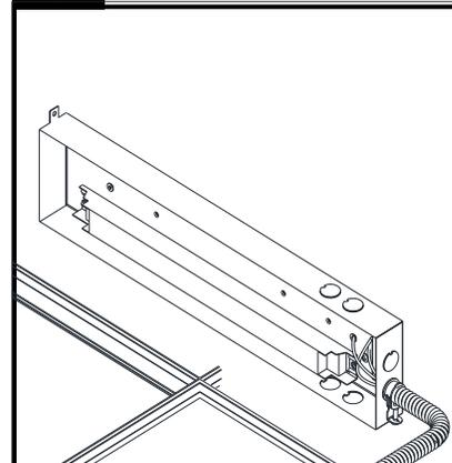
Couper l'excédent du cordon d'alimentation et compléter les connexions de câblage dans le boîtier du module de régulateur. Une fois les connexions complétées, réinstaller le couvert du module de régulateur et les vis retirées à l'étape 19.
