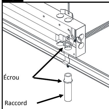
Retirer l'entrée défonçable à l'endroit désiré. Installer l'écrou sur le raccord inclus dans la trousser de montage. S'assurer que l'écrou est installé au bas de la section fileté. Rattacher le raccord à l'intérieur du module de régulateur avec le second écrou. S'assurer que le raccord est bien serré.
