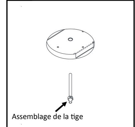
Commencer à visser l'assemblage de tige préparé à l'usine dans la plaque supérieure. **IMPORTANT** : Arrêter après environ 1 pouce et passer à l'étape suivante.
