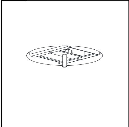
Installer le boulon 1/4po-20 dans la cavité de câblage du module de régulateur et le tirer par le trou central tel qu'illustré.
