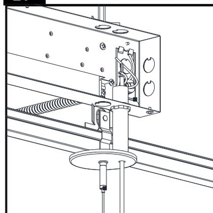
Entrer l'excédent de fil dans le boîtier du module de régulateur. Couper à la longueur désirée et compléter les connexions électriques.
