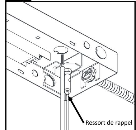
Vous référer aux directives d'installation fournies avec le luminaire pour une installation adéquate. Une fois les luminaires installés, effectuer les réglages nécessaires du serre-câble en poussant sur le ressort de rappel. **IMPORTANT:** s'assurer que les sections du luminaire sont bien supportées avant de faire les réglages.
