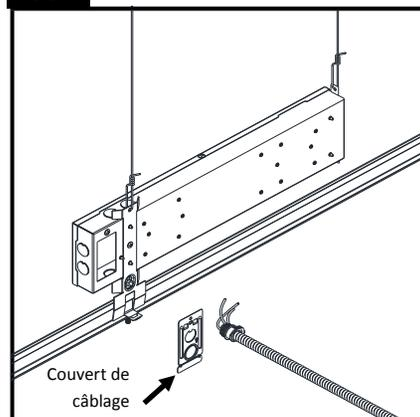
Approcher le conduit d'alimentation (non inclus) et ouvrir le couvert de câblage inclus dans la trousse de fixations.
