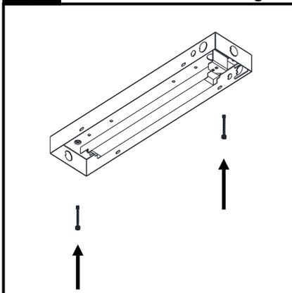
Installer le module de régulateur à l'endroit de montage requis. Rattacher à la structure à l'aide des attaches de fixations adéquates (non incluses).
