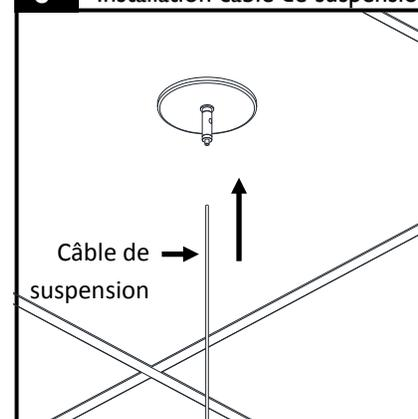
Insérer le câble de suspension dans le serre-câble et pousser vers le côté sortie. **IMPORTANT** : vous assurer que le câble de suspension est visible dans le port de sortie du serre-câble.
