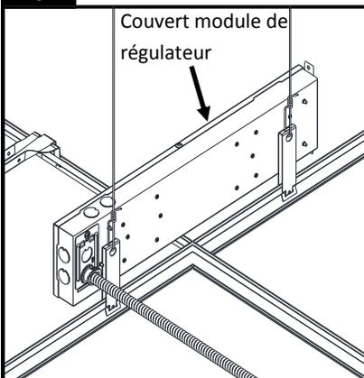
Incliner et glisser le couvert de câblage dans l'ouverture du module de régulateur pour le fixer en place. Retirer le module de régulateur et 3 vis.
