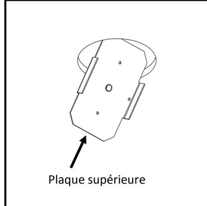
Percer un trou de 4-1/2 po de diamètre à la location de montage recherché.
