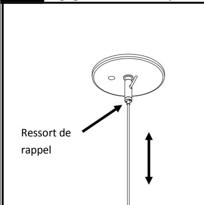
Le réglage du câble s'effectue en appuyant sur le ressort de rappel. **ATTENTION** : vous assurer que le luminaire est bien supporté avant d'effectuer les réglages. Une fois les réglages terminés, couper l'excédent du câble sous le plafonnier.
