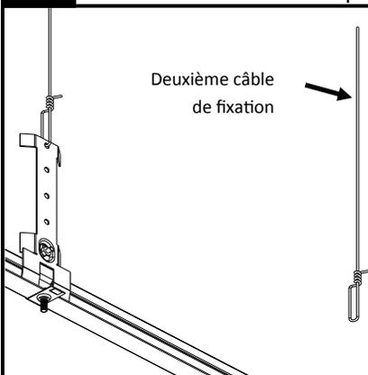
Installer un autre câble de fixation à environ 17 pouces du premier câble de fixation.
