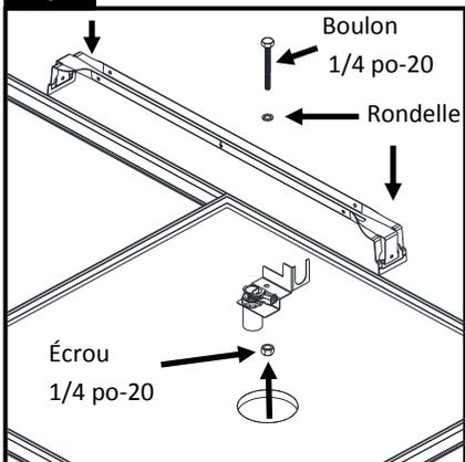
Insérer le boulon et la rondelle dans la fente de la barre transversale. Positionner l'assemblage de support sous la barre transversale et insérer le boulon dans le trou central. Bien serrer avec l'écrou inclus. Centrer la barre transversale au-dessus du trou central et enclencher sur le profilé en T.
