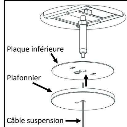
Glisser le plafonnier et la plaque inférieure sur le câble de suspension et les descendre jusqu'au luminaire. Insérer le câble de suspension dans le serre-câble et pousser vers le côté sortie. **IMPORTANT** : s'assurer que le bout du câble de suspension est visible dans le port de sortie du câble.
