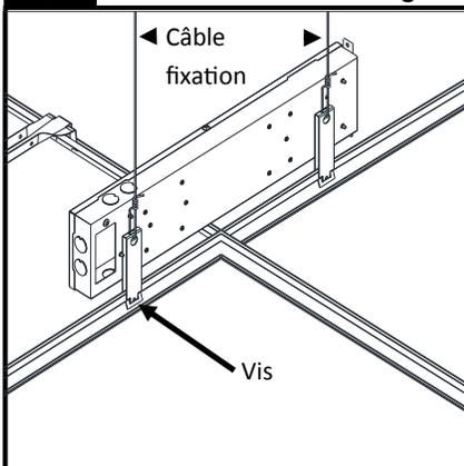
Enclencher les agrafes de grille sur le profilé en T et rattacher avec les fixations adéquates (non incluses).
