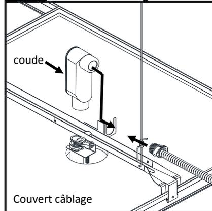
Installer le coude de conduit inclus sur le support avec le conduit et le connecteur (non inclus). Retirer le couvert de coude et raccorder le câblage épissé au témoin/interrupteur installé dans le plafonnier à l'étape 22 de la page 3. Réinstaller le couvert du coude après avoir effectué toutes les connexions.
