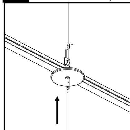
Insérer le câble de suspension dans le serre-câble et pousser du côté sortie.
