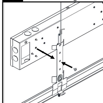
Rattacher le module de régulateur sur le support avec la vis à tôle incluse dans la trousse de fixations.
