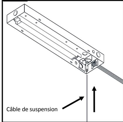
Insérer le câble de suspension dans le couvert du boîtier retiré à l'étape 12. Insérer le câble dans le serre-câble et pousser vers le côté de la sortie. **IMPORTANT:** s'assurer que le bout du câble de suspension est visible dans le port de sortie du serre-câble.
