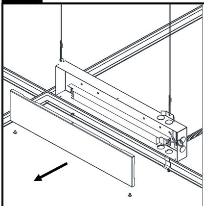
Retirer le module de régulateur et les 3 vis.
