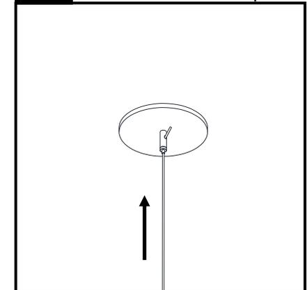
Insérer le câble de suspension dans le serre-câble et pousser vers le côté sortie. **IMPORTANT** : vous assurer que le câble de suspension est visible dans le port de sortie du serre-câble.
