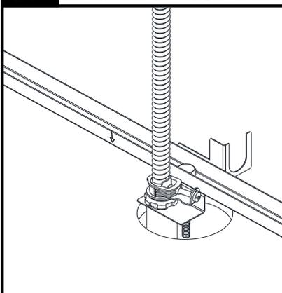
Rattacher le conduit flexible sur le support et le connecteur de conduit installés à l'étape 13 de la page 2.
