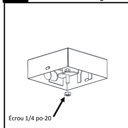
Installer le boulon préparé à l'étape 5 dans le trou du support de montage tel qu'illustré. Installer le deuxième 1/4 po-20 pour rattacher au support de montage. **IMPORTANT :** s'assurer que l'écrou est bien serré sur le boulon.
