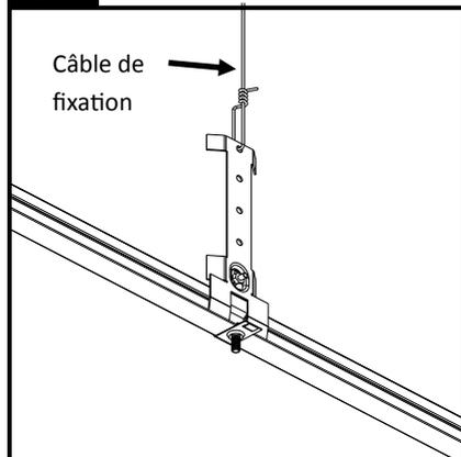
**IMPORTANT:** rattacher le support du module de régulateur sur la structure à l'aide des câbles de fixation approuvées (non inclus).
