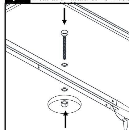
Installer le boulon 1/4 po-20 et 2 rondelles tel qu'illustré. Centrer au-dessus du trou de montage et serrer entièrement sur la barre verticale Caddy.
