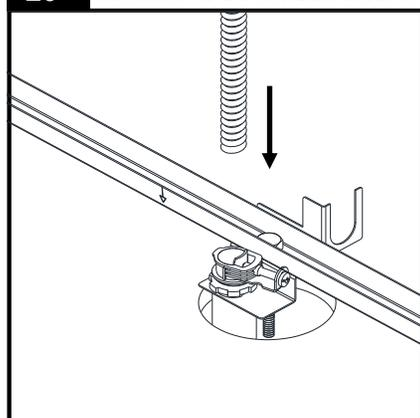
Approcher le conduit flexible au-dessus de l'alimentation et couper l'excédent de longueur.
