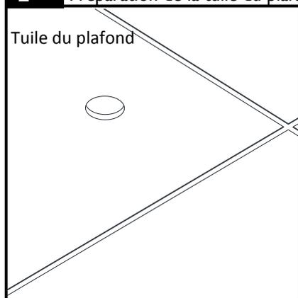
Consulter les dessins du plan fourni pour déterminer les locations exactes de montage. Sous le plafond avec une scie-cloche percer un trou de 1-1/2 ou 2po dans la tuile où sera le montage.
