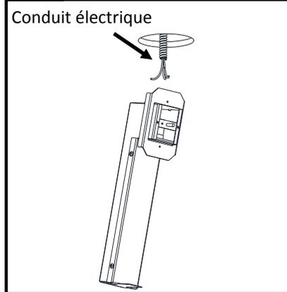
Percer un trou de 4-1/2 po à l'endroit de montage recherché. Saisir le conduit d'alimentation (non inclus) et l'insérer dans le trou du plafond. Raccorder le conduit et les connecteurs dans le trou de 7/8 po du côté c.a. du module de régulateur. Rentrer les fils c.a. dans la cavité de câblage.
