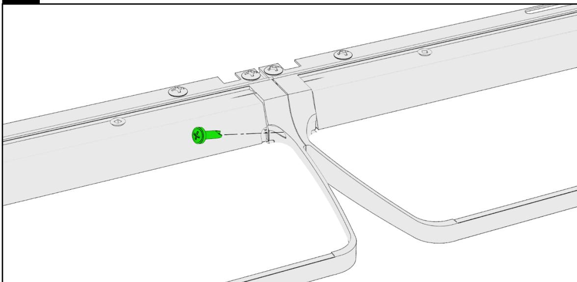
POUR CONNECTER LES LUMINAIRES, INSTALLER L'AUTRE VIS DE RACCORD INCLUSE ET SERRER DOUCEMENT.
