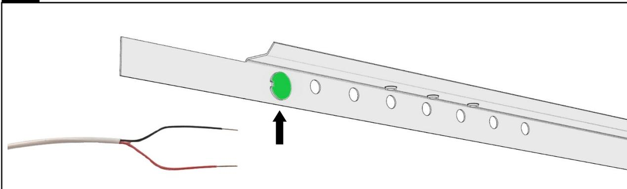
RETIRER L'ENTRÉE DÉFONÇABLE ET INSÉRER LES ALIMENTATIONS C.C. DANS LE RAIL.
