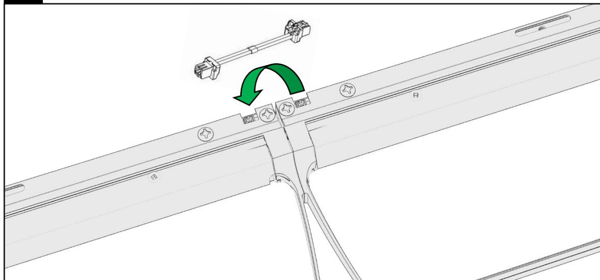
LES FILS DE RACCORDEMENT SONT FOURNIS AFIN QU'UN MODULE ALIMENTE LES AUTRES SECTIONS DE L'ENFILADE.
