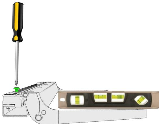
EN DÉBUTANT À UNE EXTRÉMITÉ DE L'ENFILADE, AJUSTER LA VIS DE MONTAGE ARRIÈRE JUSQU'À CE QUE LA SECTION SOIT NIVELÉE.
