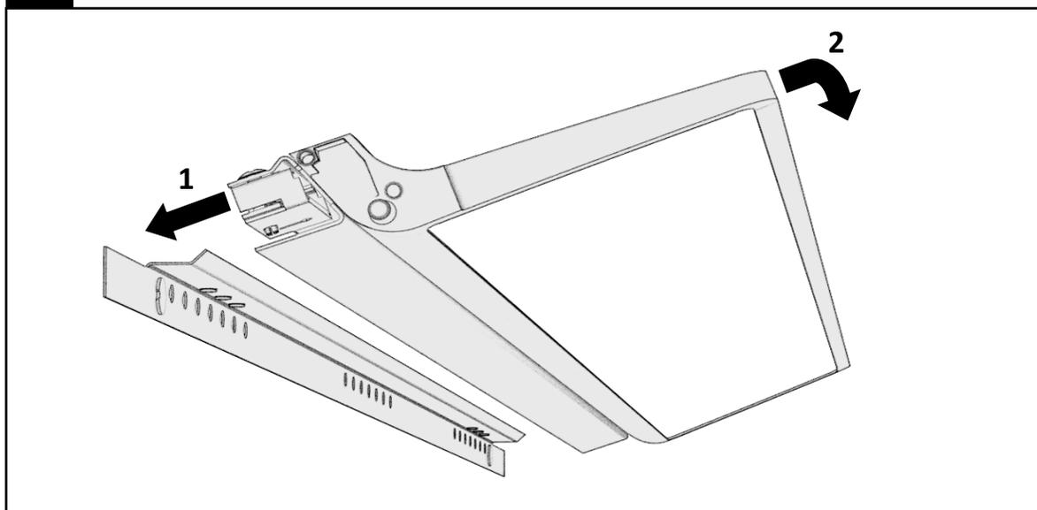
INSTALLER LE LUMINAIRE EN L'ACCROCHANT SUR LE RAIL MURAL ET L'ABAISSEUR POUR LE NIVELER.
